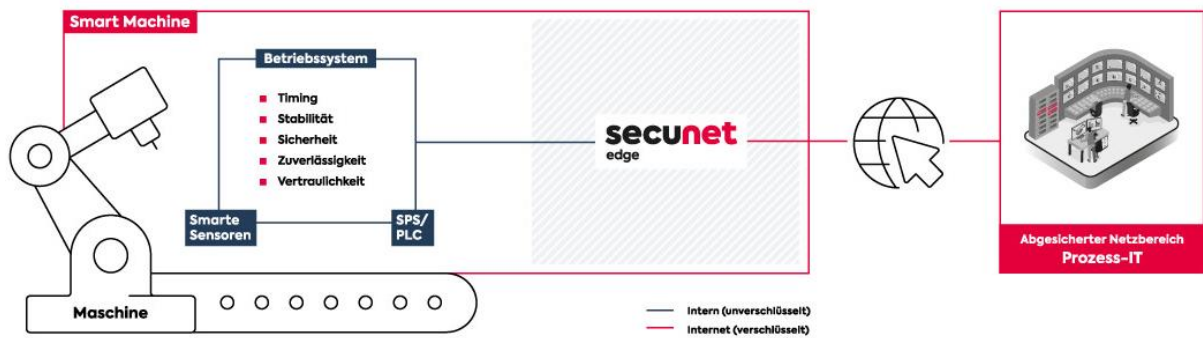
Abbildung 1: Integration des Sicherheitssystems als Kommunikationsschnittstelle zwischen Maschine und Netzwerk
